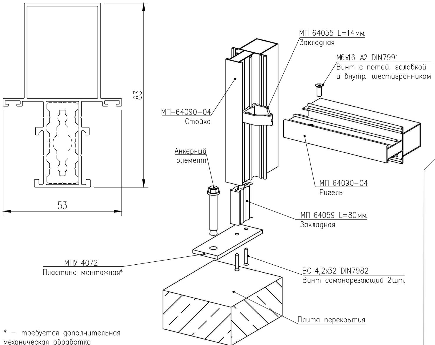
\* — требуется дополнительная механическая обработка отверстия под анкер
